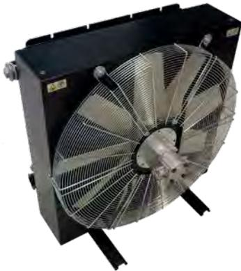
Diese Kühlertypen mit Hydraulikmotor ist für stationäre und Mobilanwendungen konzipiert und dient vor allem zur Kühlung von unterschiedlichen Ölen (Hydraulik, Schmier, ...) und Wasser/Glycol Mischungen (> 15 % Glycol). Das mögliche Schluckvolumen der Motoren reicht von 4 cm<sup>3</sup> bis 45 cm<sup>3</sup>. Ausführungen inkl. diverssem Zubehör und als 1-Pass, 2-Pass oder 3-Pass möglich.
